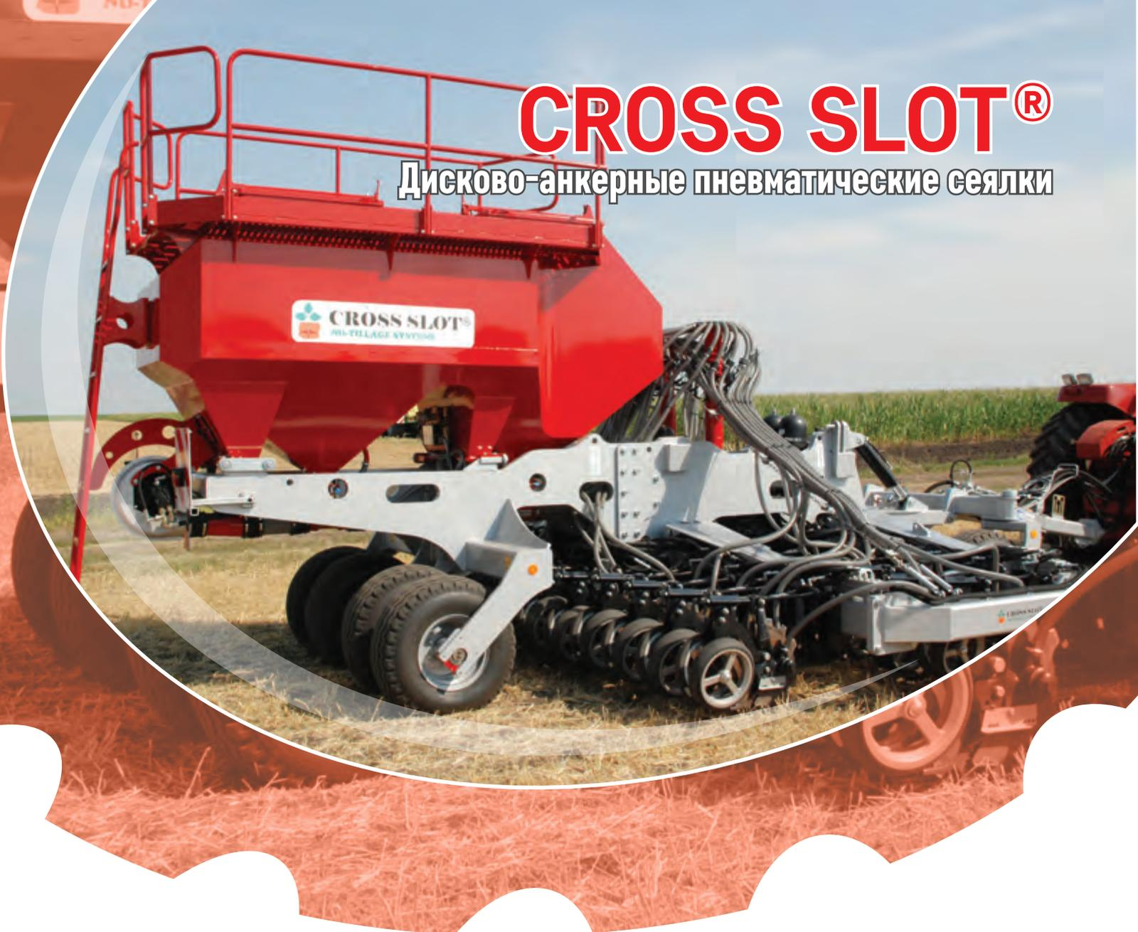
Пневматическая сеялка **Cross Slot®** – посевной комплекс нового поколения, разработанный специально для нулевой технологии.
